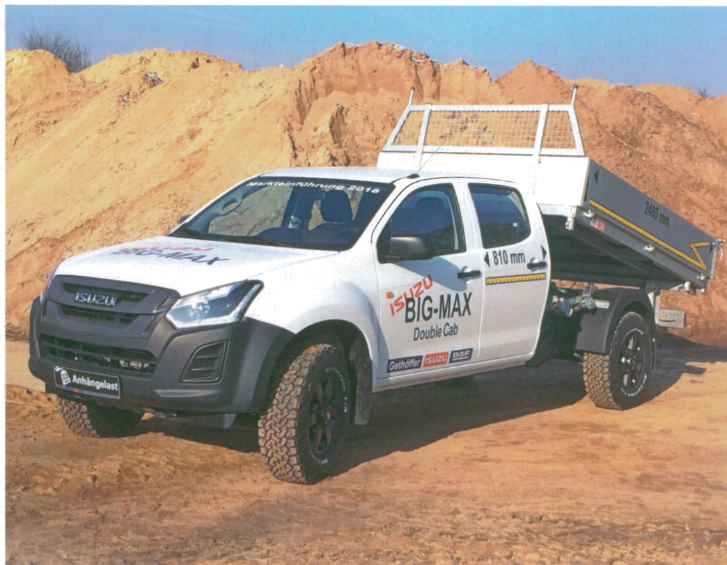
Das Big-Max Double Cab der Firma Gethöffer hat 0,81 m Platz für die Rücksitze. Der Kipper ist 2,48 m lang.
